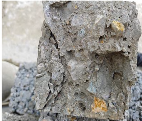
图6 加入高吸水树脂的混凝土试件被劈开后示意图
